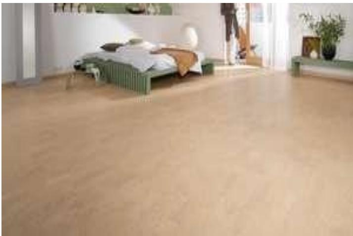
El linóleo es un producto natural como el corcho. Se compone de aceite de linaza – que se extrae de las semillas del lino – resinas naturales, roca calcárea molida y madera en polvo. Partiendo de estas materias primas se crean, mediante nuestro proceso de producción, suelos de linóleo llenos de color y de gran calidad. Gracias a su especial resistencia son ideales para áreas domésticas de uso elevado o áreas comerciales de uso normal.
